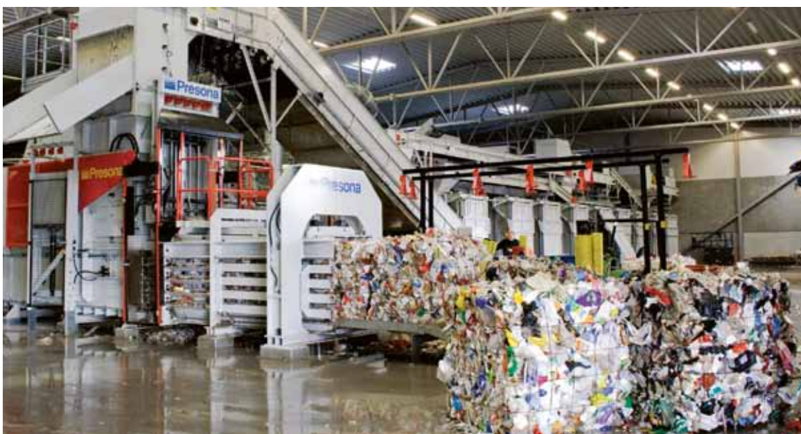
Efter sorteringen packas plasten i stora balar. Foto här Swerec, frilagda bilder på övriga sidor FTI
